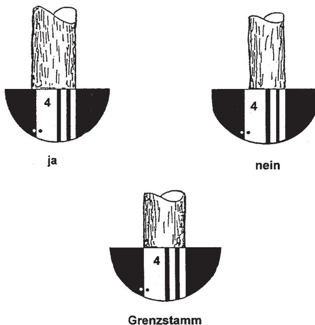
Abbildung 4: Winkelzählprobe – Zählfaktor 4 im Relaskopdurchblick
