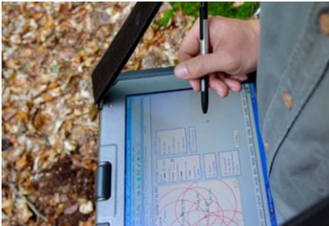
Feldcomputer helfen beim Wiederauffinden der Stichproben, bei der Datenerfassung und bei der Qualitätskontrolle der Daten.
