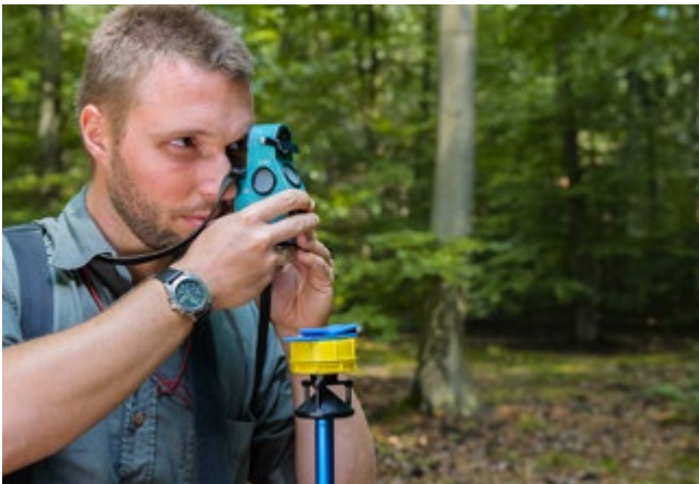
Mit Bitterlich-Relaskop und Ultraschall-Entfernungsmessgerät werden die Stichproben-Bäume der Winkelzählprobe ermittelt.
